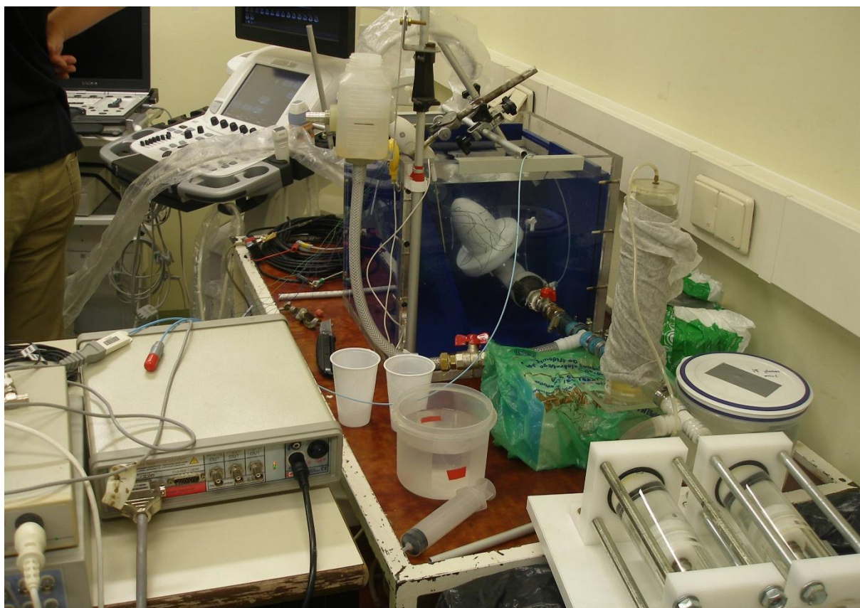
Rysunek 7. Fragment stanowiska badawczego z widocznym fantomem zanurzonym w zbiorniku oraz podłączeniem przetworników sonomikrometrycznych [archiwum własne].
