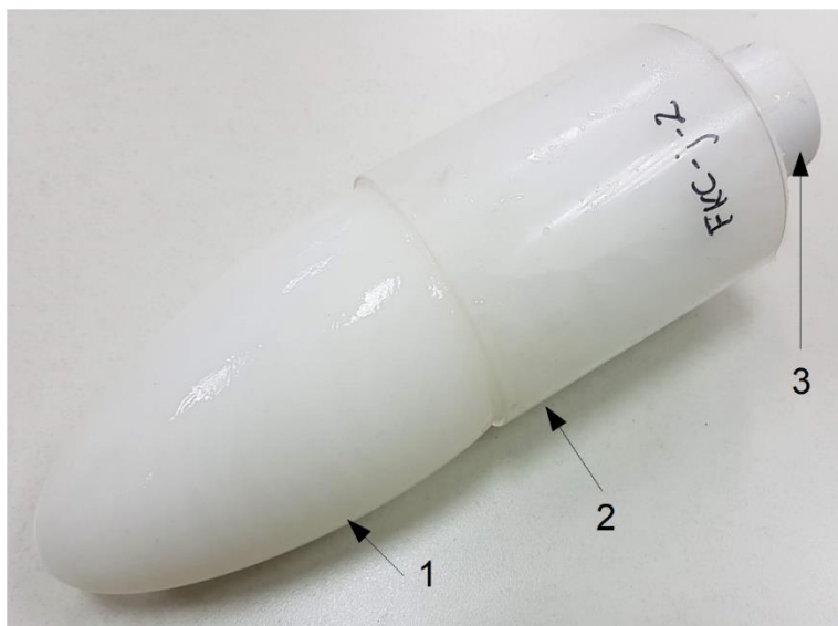
Rysunek 12. Fantom z PVA-C z przyklejonymi tulejami służącymi do jego mocowania w stanowisku. 1 - część czynna fantomu, 2 - zewnętrzna tuleja mocująca, 3 - wewnętrzna tuleja mocująca [archiwum własne].
